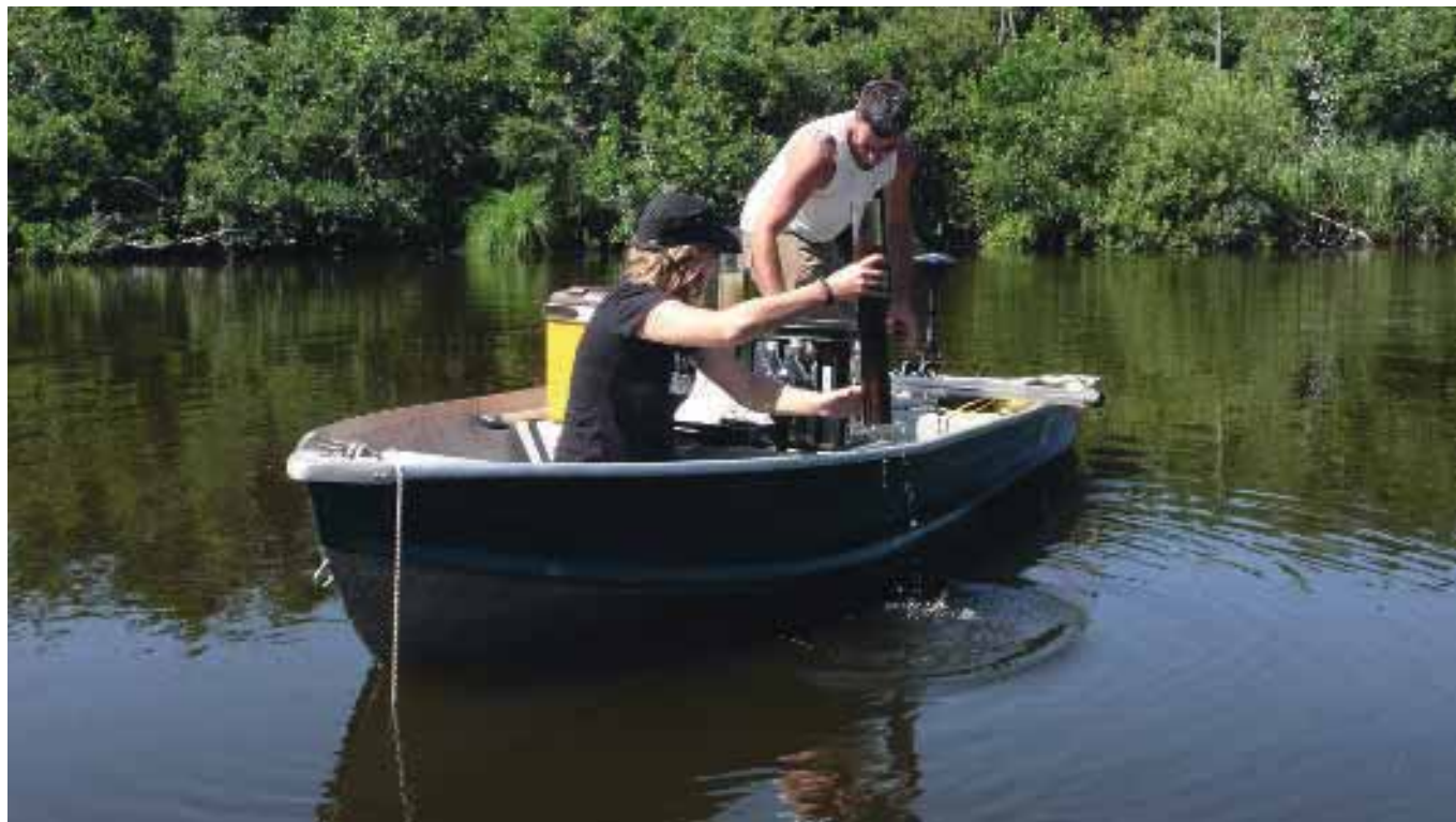
Het verzamelen van monsters en van intacte bodemkernen die direct in glazen cilinders worden aangebracht.
