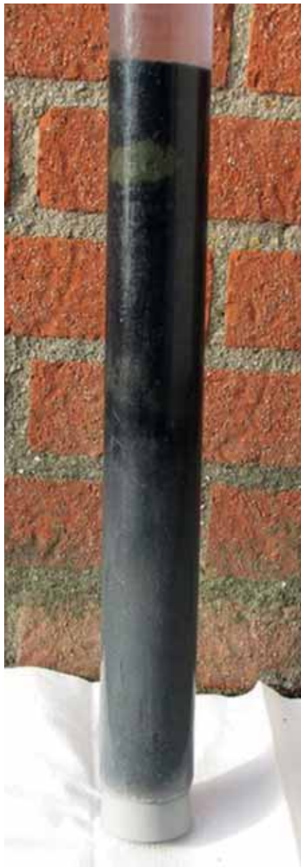
Extreme zwartkleuring van het zand en slib (dikte circa 20 cm) wijzen op de aanwezigheid van ijzersulfiden in de bodem en de rol van sulfaat in het systeem (diameter van de steekbuis bedraagt 4,5 cm).
