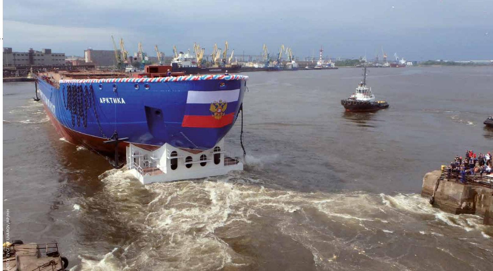
Tewaterlating van de Arktika in Sint-Petersburg. Deze atoomijsbreker van de nieuwste generatie heeft een vermogen van 60 MW.
