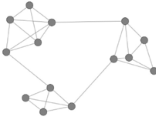
Figuur 2. Voorbeeld een 'small-world' netwerkstructuur
